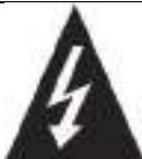
Le symbole d'avertissement montrant un éclair dans un triangle indique que ce produit contient des « tensions électriques dangereuses ».
